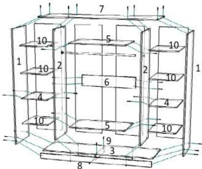
К тыльной стороне шкафа гвоздями прибить два стыкуя их соединительный брусом. Предварительно измерив диагональ.
